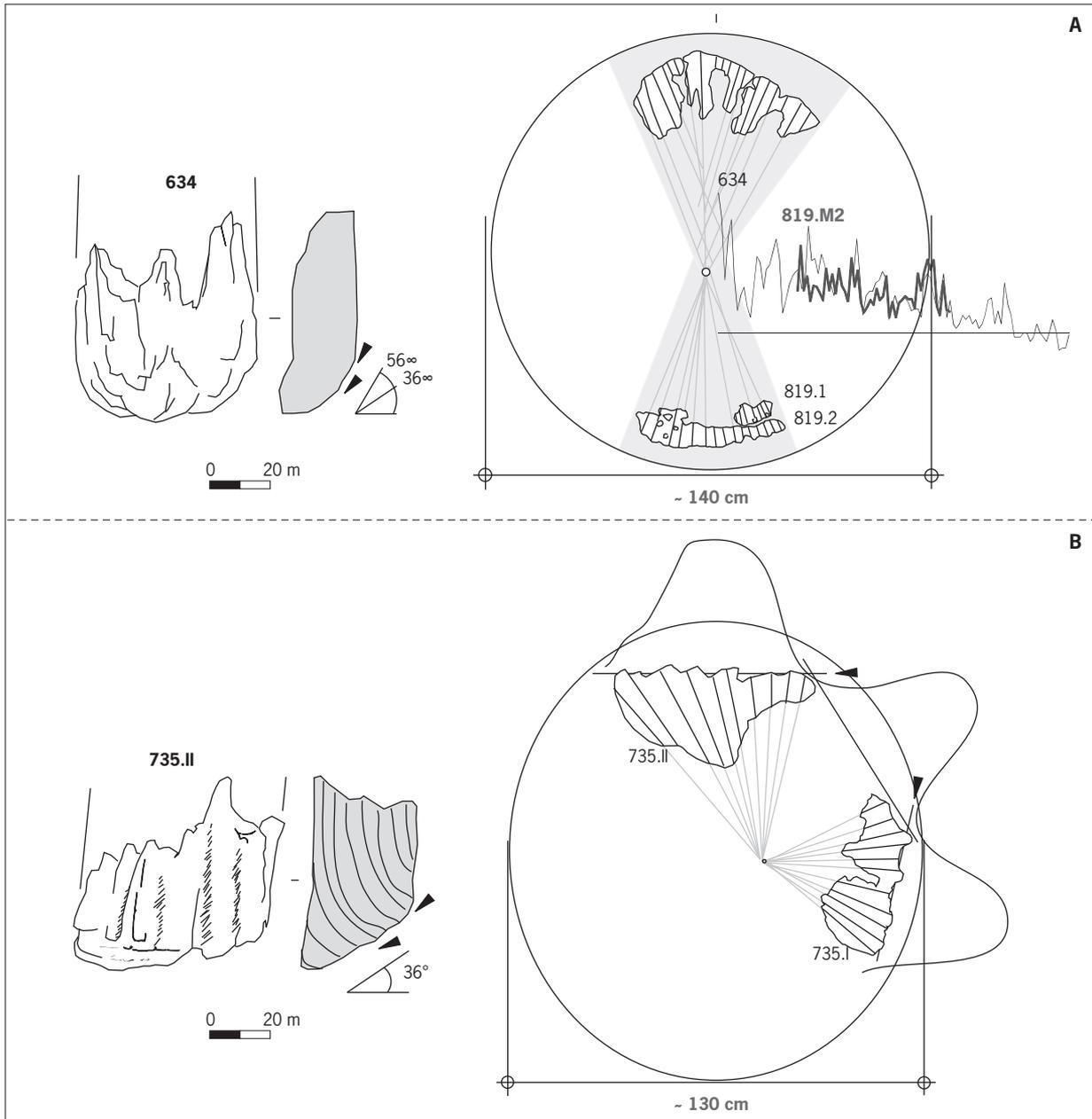
Fig. 68: Analyse des techniques d'abattage. A: restitution du mode de débitage et du façonnage de l'arbre partagé entre les structures 634 et 819; B: estimation de la section du poteau 735, mode de façonnage et de débitage (© V. Bernard, CNRS).
