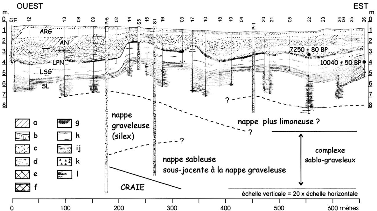
Fig. 3 : Transect est-ouest (avec projection des sondages géotechniques proches) et localisation des bois datés par radiocarbonate.
