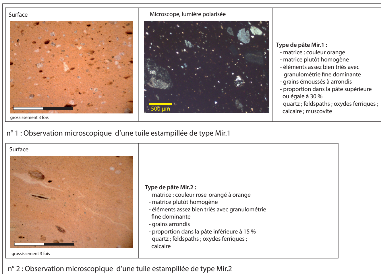
Fig. 30. Observation microscopique des tuiles estampillées. 1. Tuile de type Mir.1 ; 2. de type Mir. 2 (photos : Fl. Delencre).
