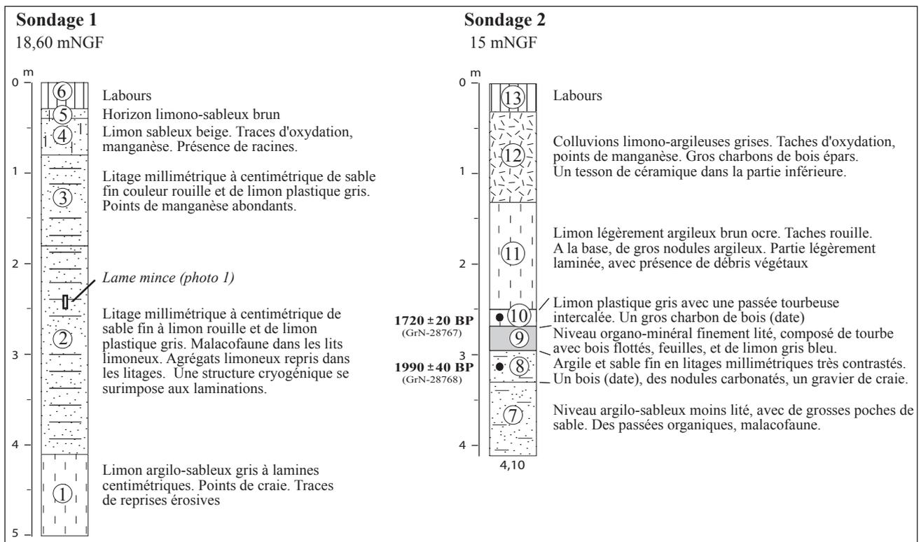
Fig. 2 : Logs stratigraphiques en haut de versant (sondage 1) et fond de vallon (sondage 2).
