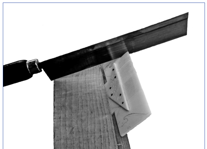
Fig. 12 — Système de maintien du peigne lors du sciage des dents (cliché : C. Picod).
