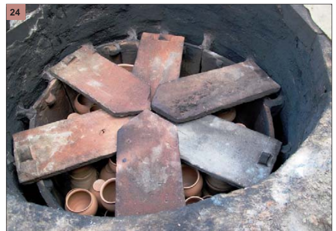
Fig. 23. Intérieur d'une réplique de four d'Autun, avec son chemisage interne. Ces plaques de chemisage, assez fines, ne peuvent pas dépasser une trentaine de centimètres de hauteur. Plus hautes, elles deviendraient très fragiles et risqueraient de se casser ou de fortement se déformer lors des cuissons. Les arrêter à mi-hauteur de la chambre de cuisson permet aussi de s'en servir comme supports d'étagère de reprise de charge. On peut donc ensuite empiler un maximum de pièces au-dessus de la "chambre à gobelets" sans que ces derniers risquent de se déformer sous la charge. © P.-A. Capt.
