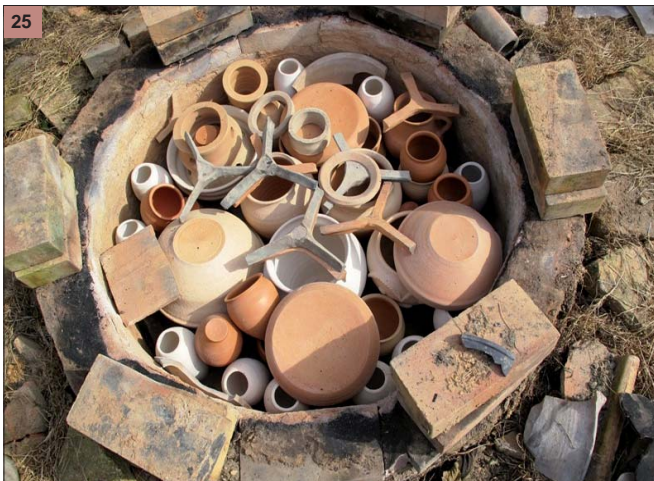
Fig. 23. Intérieur d'une réplique de four d'Autun, avec son chemisage interne. Ces plaques de chemisage, assez fines, ne peuvent pas dépasser une trentaine de centimètres de hauteur. Plus hautes, elles deviendraient très fragiles et risqueraient de se casser ou de fortement se déformer lors des cuissons. Les arrêter à mi-hauteur de la chambre de cuisson permet aussi de s'en servir comme supports d'étagère de reprise de charge. On peut donc ensuite empiler un maximum de pièces au-dessus de la "chambre à gobelets" sans que ces derniers risquent de se déformer sous la charge. © P.-A. Capt.
