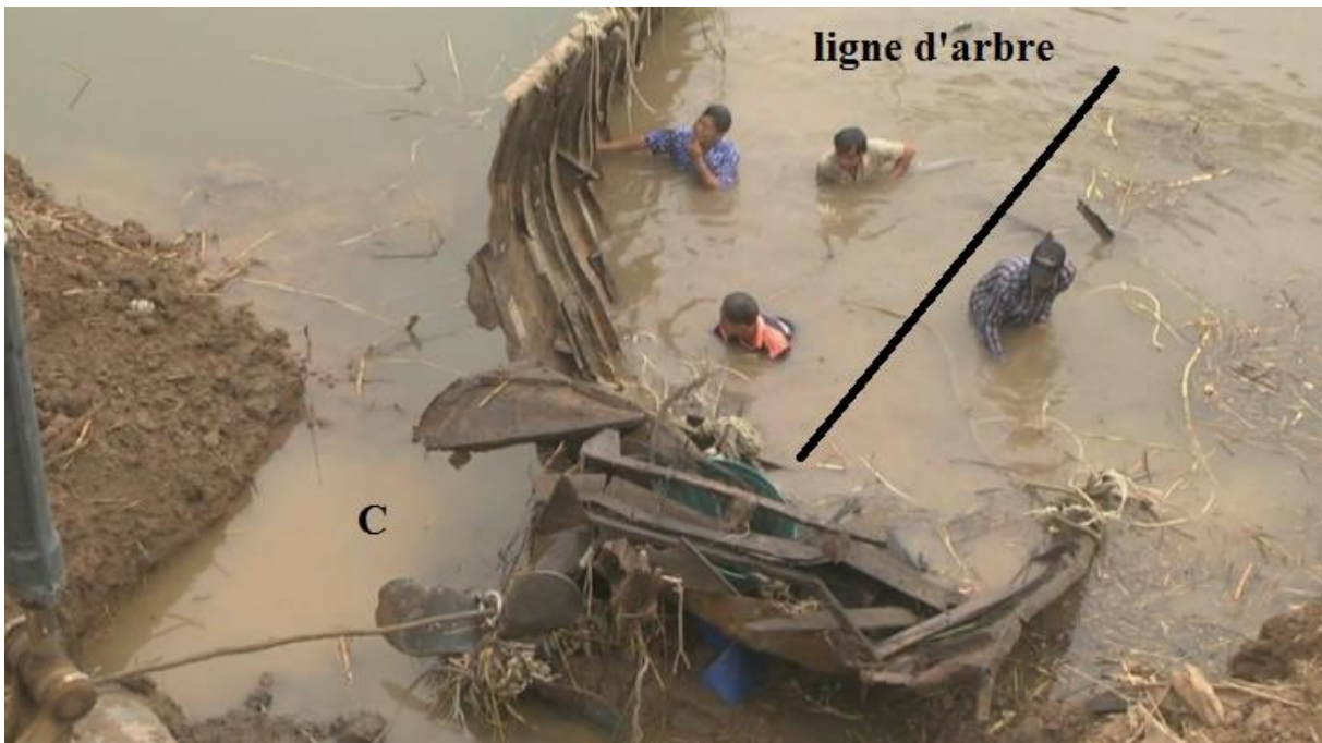
Fig.46 positionnement du propulseur C l'Hélice, la ligne d'arbre de transmission.
