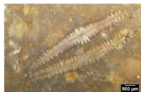
3 : texture wackestone à coupes méridiennes de Lépidorbitoïdes, échelle 500 µm.
