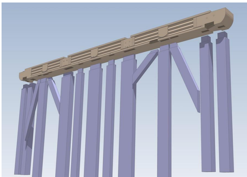
Fig. 15 : Proposition de restitution d'une façade à partir d'une sablière. Manoir du Boberil, à L'Hermitage (35).
