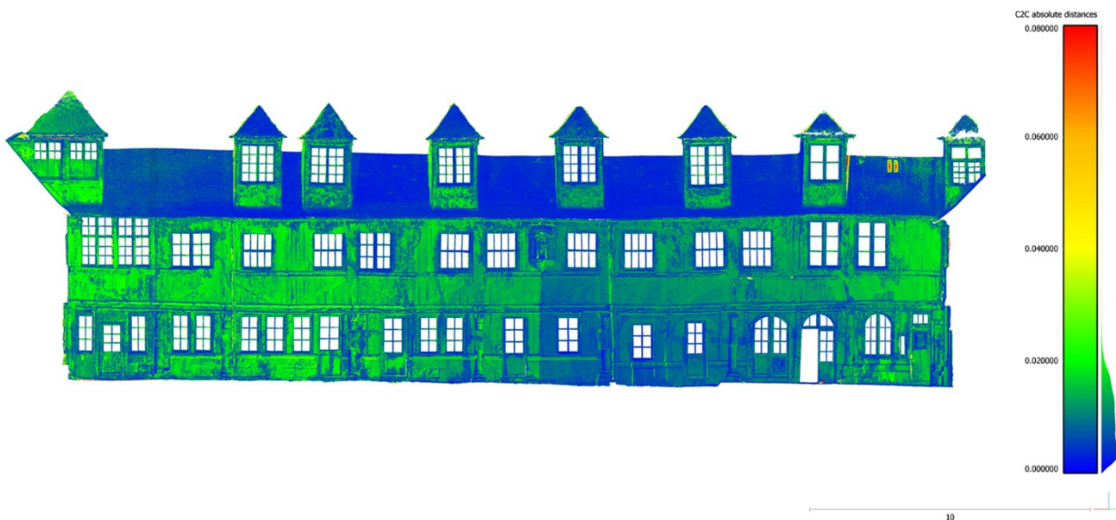
Fig. 10 : Comparaison de la photogrammétrie et du scan 3D. Aître Saint-Maclou, Rouen (76).
