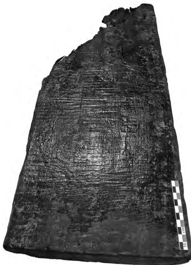
Fig. 39 : Planche en noyer (3005-1-6). Noter les stries parallèles dues au sciage © S. Hurard.
