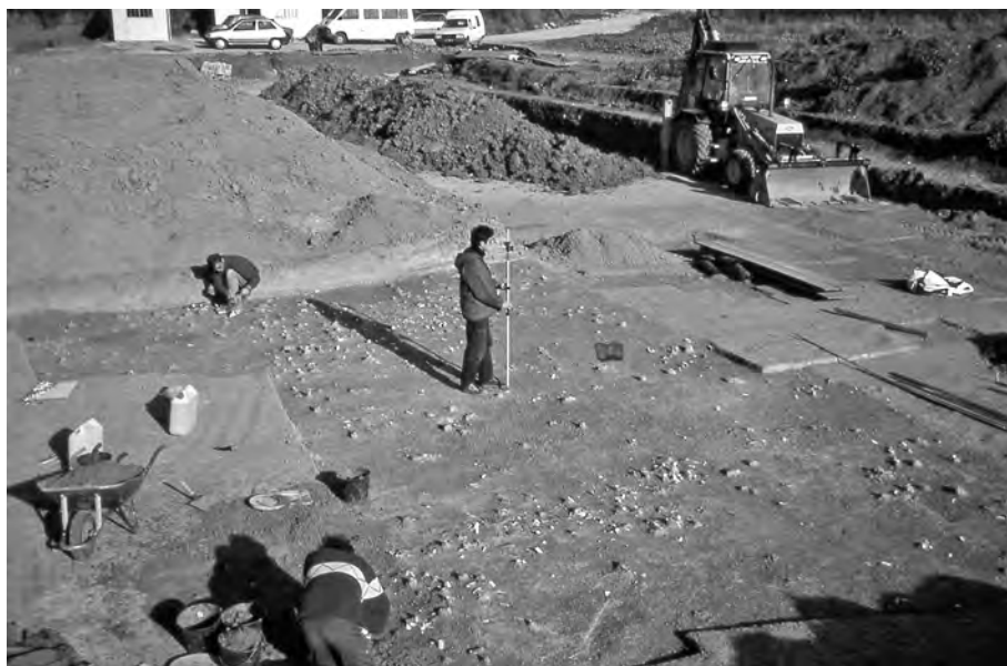
Fig. 3 : relevé au théodolite laser, fouille de Choisey les Champins.
