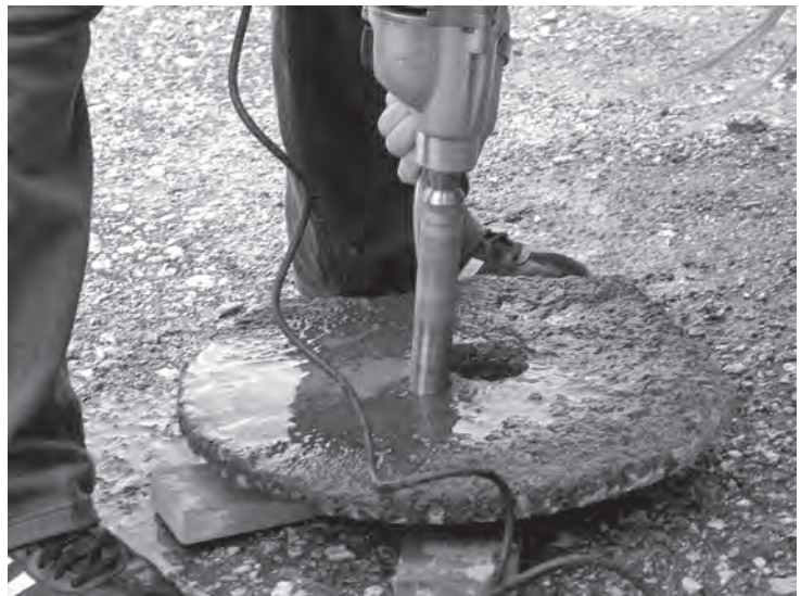
Fig. 97: Forage à la perceuse pour prélever l'échantillon (cliché L. Jaccotey).
