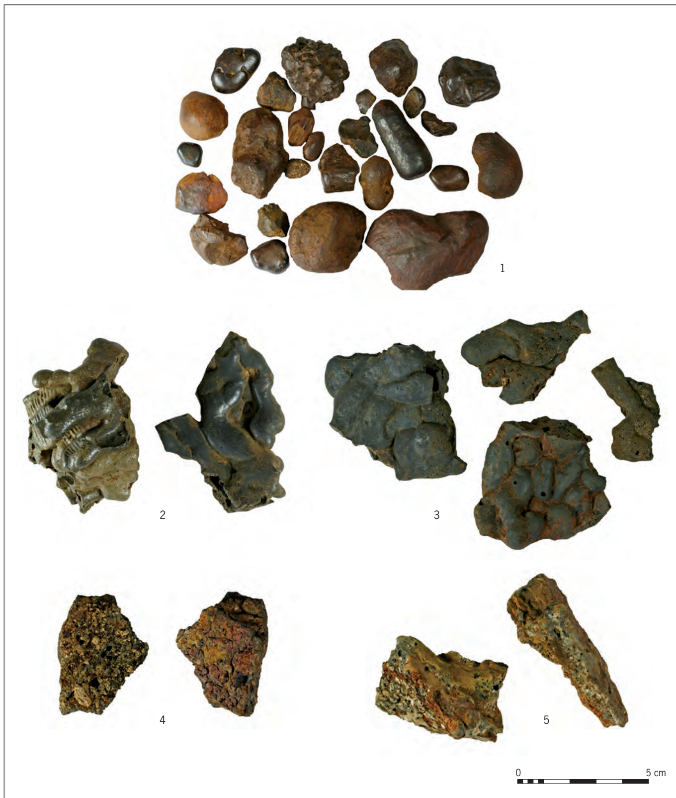
Fig. XI: 1 : minerai brut; 2-3 : scories d'aspect coulé; 4-5 : éléments de parois (clichés P. Haut).
