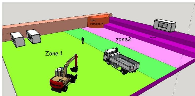
**Fig. 3 : Croquis 3D préparatoire à la fouille et à la mise en forme des talus de sécurité.** Les différentes couleurs marquent les limites des zones de fouille. Stéphane Augry, Inrap.
