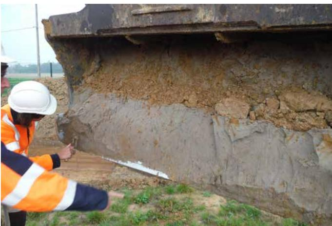
**Fig.30** : SP1, limon gleyifié homogène en fond de sondage vu dans le godet de la pelle.
