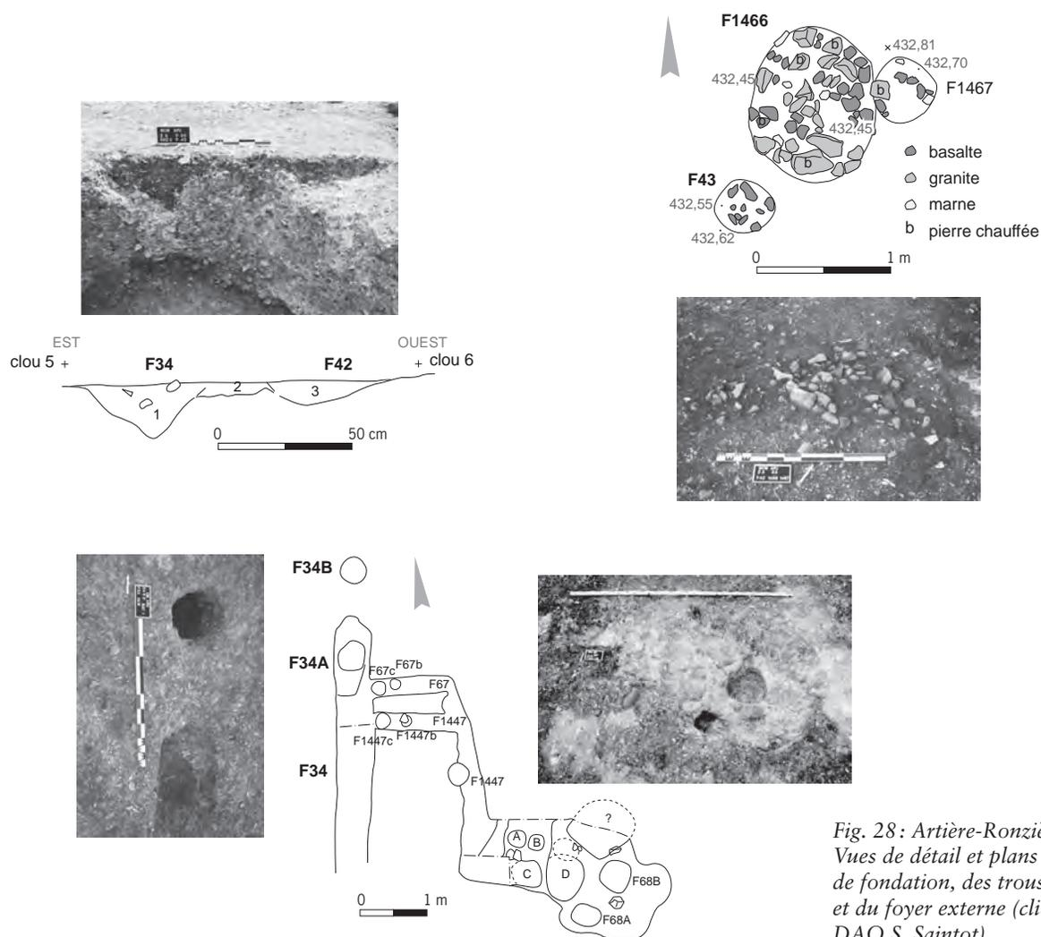
Fig. 28 : Artière-Ronzière. Bâtiment 1. Vues de détail et plans des tranchées de fondation, des trous de poteau et du foyer externe (clichés et DAO S. Saintot).
