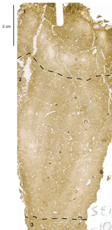
Ums 1 : Assemblage dense de plages argilo-limoneuses et plus sableuses ; intercalations argilo-poussiéreuses rubéfiées (combustion plus forte)
