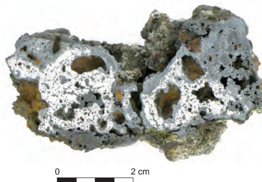
Fig. 47: Section d'une scorie en culot contenant des fragments de fer tombés au cours du travail de forge à « la Justice ». © M. Leroy et P. Merluzzo, LMC-IRAMAT.
