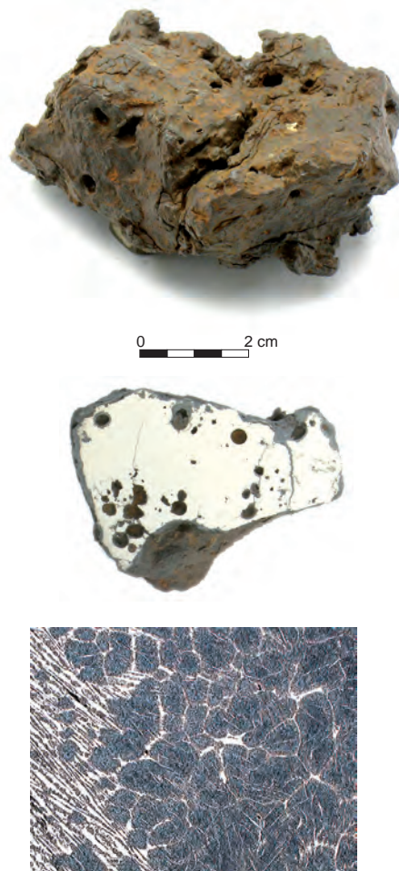
Fig. 84 : Petit bloc d'acier très carburé retrouvé parmi les déchets d'atelier autour du bâtiment ouest de « Mégazone » à Illange : forme grossièrement parallélépipédique, surfaces irrégulières, dont une avec des reliefs lobés, une autre avec des vacuoles. Une des faces évoque une surface aplatie (mise en forme). Métal à structure dense, contenant quelques vacuoles plurimillimétriques. L'aspect général semble indiquer qu'un état de fusion a été atteint. Il s'agit d'un fer très carburé proche de la fonte. © M. Leroy et P. Merluzzo, LMC-IRAMAT.
