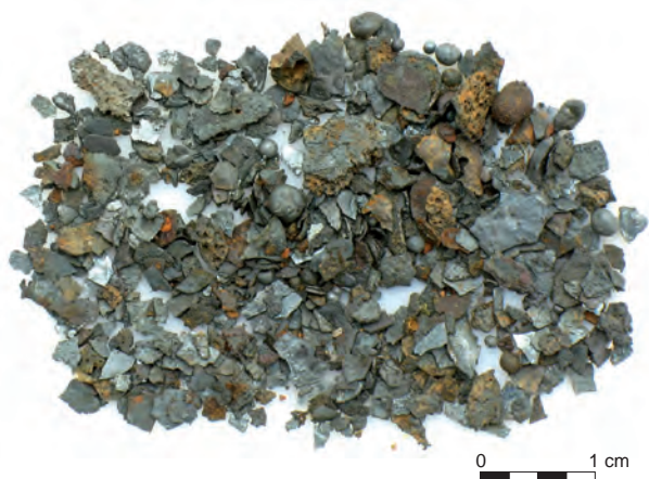
Fig. 18 : Battitures de forge recueillies après tamisage de sédiment et tri à l'aimant du refus de tamis.
