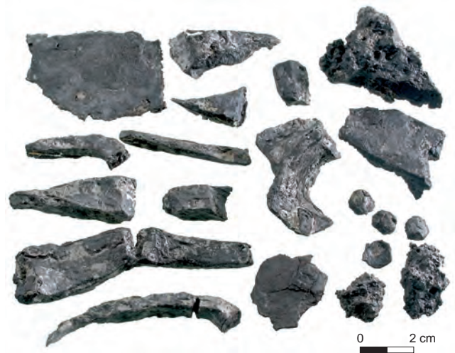
Fig. 14: Déchets métalliques de forge: chutes informes à surfaces grenelées, chutes facettées, chutes façonnées, soies de préhension, portant des empreintes et des traces de gestes techniques (coupe, découpe, préhension, martelage). © M. Leroy et P. Merluzzo, LMC-IRAMAT.
