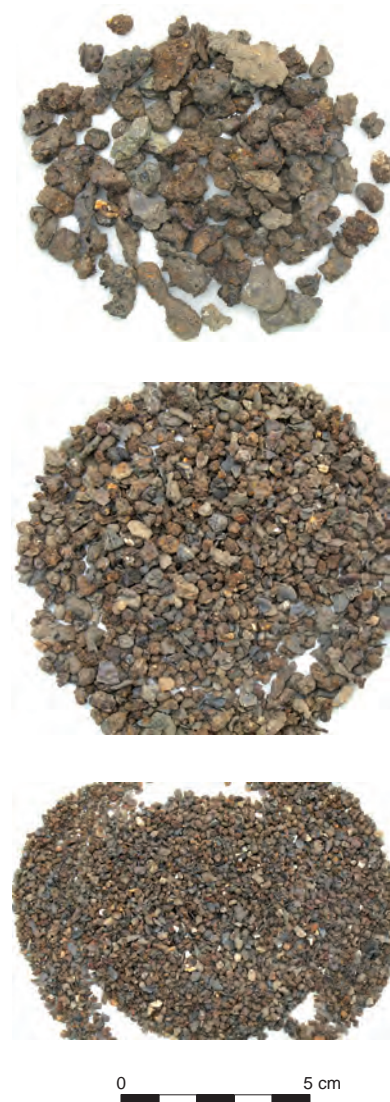
Fig. 16 : Exemples de différents modules et catégories de petits et très petits déchets magnétiques et métalliques. © M. Leroy et P. Merluzzo, LMC-IRAMAT.
