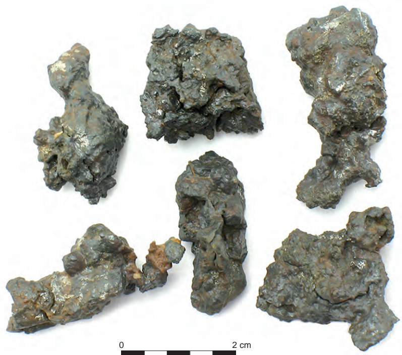
Fig. 50: Débris métalliques informes du « Bois Bruneau » pouvant être issus des travaux de compactage du métal brut. © C. Dunikowski, Inrap, et P. Merluzzo, LMC-IRAMAT.
