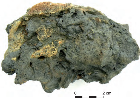
Fig. 43 : Scorie de forge en forme de culot à laquelle adhère un morceau de la paroi du foyer mise au jour à « Charmoy ». © L. Cabboi, Inrap, et P. Merluzzo, LMC-IRAMAT.
