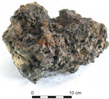
Fig. 41 : Bloc de scorie de fond de four aggloméré à la base de la cuve d'un fourneau de réduction du type « à scorie piégée », provenant du comblement de la structure 28 de « Charmoy » (largeur 25 cm, épaisseur 15 cm, 10 kg). Morphologie d'écoulements sous forme de petites coulures, verticaux ou obliques, moulant des négatifs de charbons de bois de taille centimétrique. © L. Cabboi, Inrap, et P. Merluzzo, LMC-IRAMAT.
