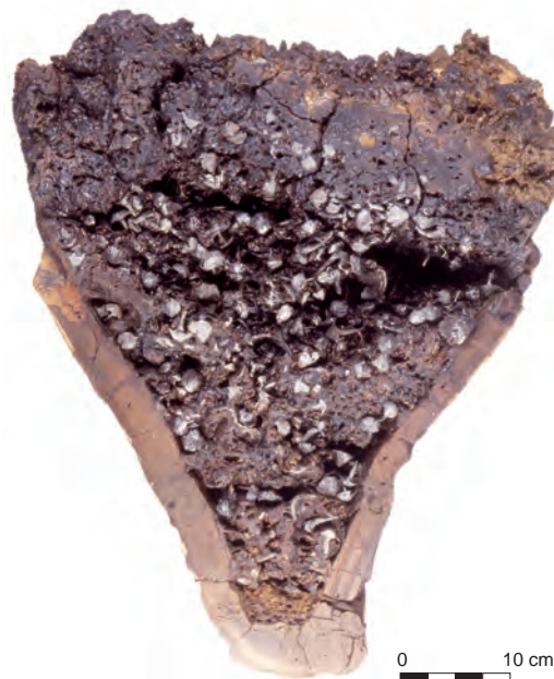
Fig. 58 : Fond d'amphore rempli d'objets cassés en fer destinés au recyclage, découvert lors des fouilles des années 1980 au lieu-dit « Gehren ». On observe des petits clous, usagés ou ébauchés, agglomérés entre eux par l'oxydation, quelques clous usagés de plus grande taille, une petite barre de fer et des fragments d'objets en bronze. Ces éléments sont des fragments d'objets probablement stockés en attente de leur recyclage. © conservation musée de la Tour aux Puces, Thionville; coupe et cliché P. Merluzzo, LMC-IRAMAT.
