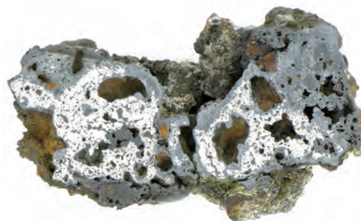
Fig. 47: Section d'une scorie en culot contenant des fragments de fer tombés au cours du travail de forge à « la Justice ». © M. Leroy et P. Merluzzo, LMC-IRAMAT.
