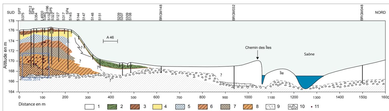
**Fig. 3 : Coupe synthétique de la plaine alluviale de la Saône à Quincieux à partir des sondages de 2012 et 2013 et de trois sondages du BRGM.** 1/ terre de labour, 2/ colluvion, 3/ sol supérieur, 4/ less, 5/ limon, 6/ horizon brunifié médian, 7/ sable limoneux, 8/ paléosol inférieur, 9/ sable grossier, 10/ gravier, 11/ restes de faune.
