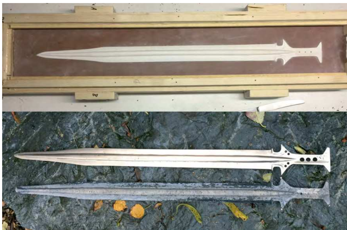
Fig. 5 – En haut : vue d'un modèle en bois dans son cadre ; en bas : vue des deux épées coulées, l'une finie, l'autre encore brute de fonte (Clichés T. Brasseur).
