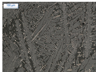
7 : Faciès supérieur à longues lattes de fayalite et fines dendrites de wustite
