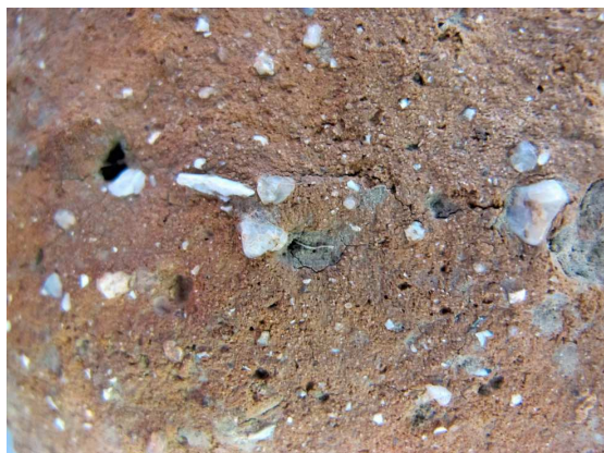
Fig. 3.3.3 : Inclusions de quartz visibles en surface de la céramique 2144-27 (© INRAP, cliché H. Civalleri)
