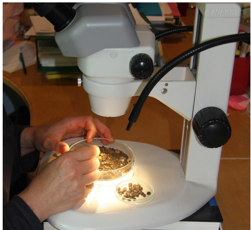
Fig. 2 - Un carpologue en phase de tri des restes carpologiques sous loupe binoculaire, à l'aide de pinces spécifiques. (F. Toulemonde, MNHN)
