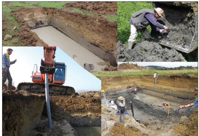
Fig. 3 - Tranchée ennoyée à Autrecourt-et-Pourron, prélèvement dans le godet à Fépin, essai de prélèvement en tube PVC sur l'A34, tranchée avec paliers de sécurité à Autrecourt-et-Pourron. (Montage et photos de gauche : Henri-Georges Naton, Géoarchéon. Photos de droite : Olivier Brun, Conseil Départemental des Ardennes)
