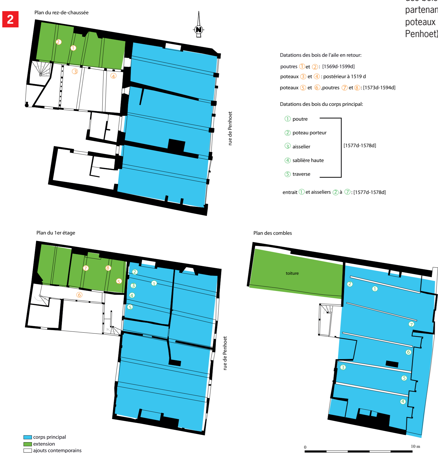
2. Localisation des bois datés par dendrochronologie du bâtiment du 25-27 rue de Penhoët (données Dendrotech). © M. Millet - Inrap
