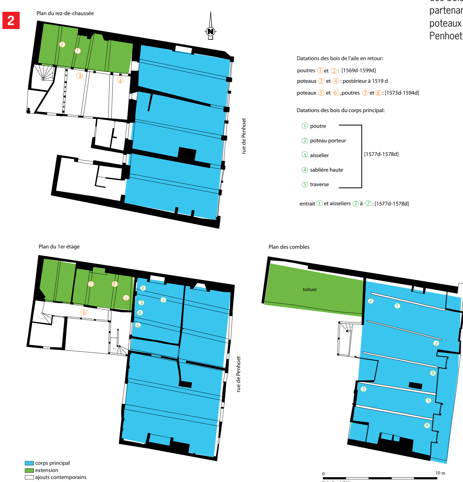
2. Localisation des bois datés par dendrochronologie du bâtiment du 25-27 rue de Penhoet (données Dendrotech). © M. Millet - Inrap
