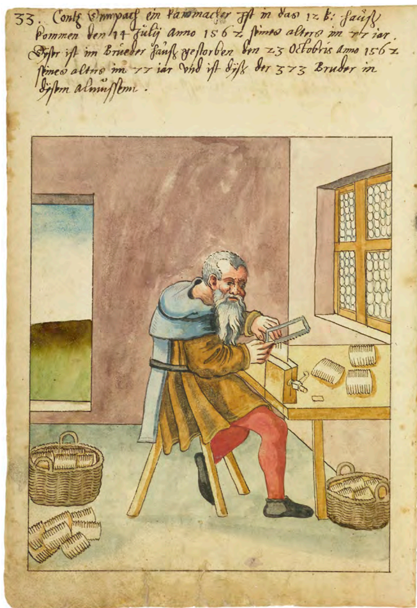
Fig. 202. Contz Dumbach, peignier en buis. L'artisan taille les dents avec une scie d'un peigne bloqué sur un étau (Nuremberg, Nürnberg Germanischen Museum, Stadtbibliothek, Das Hausbuch der Medelsen, Mendel I, Amb. 317,2, fol. 15v, feuillet daté de 1562).
