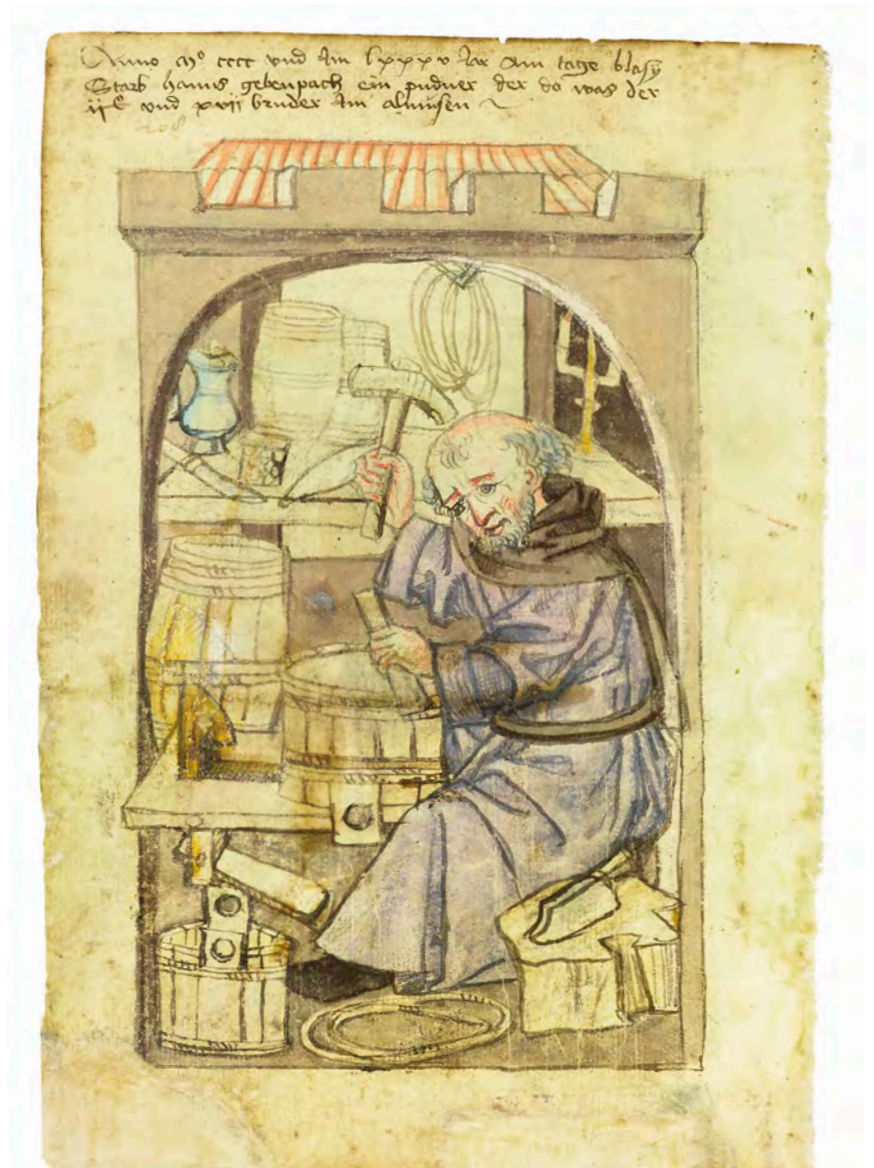
Fig. 176. Hans Gebenpach, tonnelier-cuveleur, sur sa selle de travail cerclant un baquet à l'aide d'un maillet et d'une chasse. À ses pieds et derrière lui, des baquets, tonneaux et tonnelets finis et des cercles en bois liés (Nuremberg, Nürnberg Germanischen Museum, Stadtbibliothek, Das Hausbuch der Medelsen, Mendel I, Amb. 317,2, fol. 103v, vers 1485).
