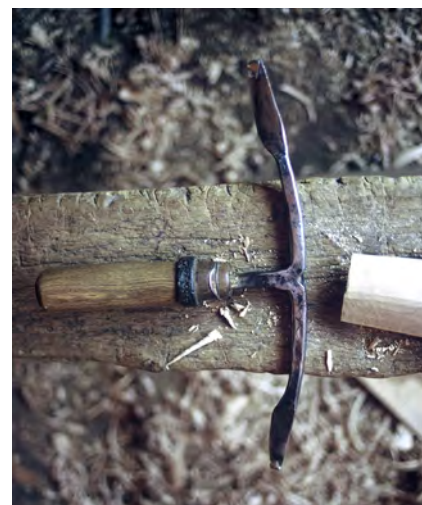
Fig. 104. Une rainette double pour le rainurage des planches de meuble, Roumanie Budureasa, Bihor, enquête auprès de Nicolae Oancea, coffretier, 1994 (d'après Mille, 1994, p. 12; photo P. Mille).
