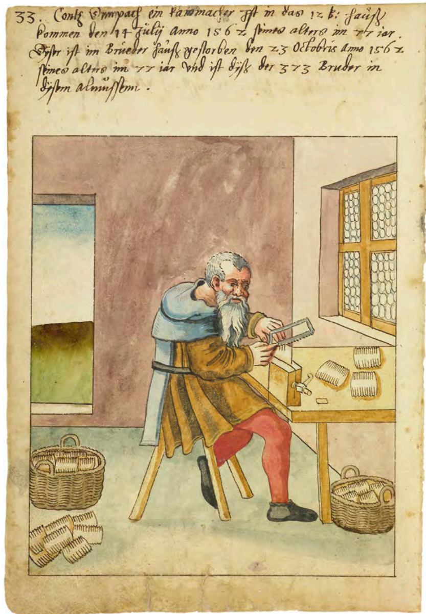
Fig. 202. Contz Dumbach, peignier en buis. L'artisan taille les dents avec une scie d'un peigne bloqué sur un étau (Nuremberg, Nürnberg Germanischen Museum, Stadtbibliothek, Das Hausbuch der Medelsen, Mendel I, Amb. 317,2, fol. 15v, feuillet daté de 1562).
