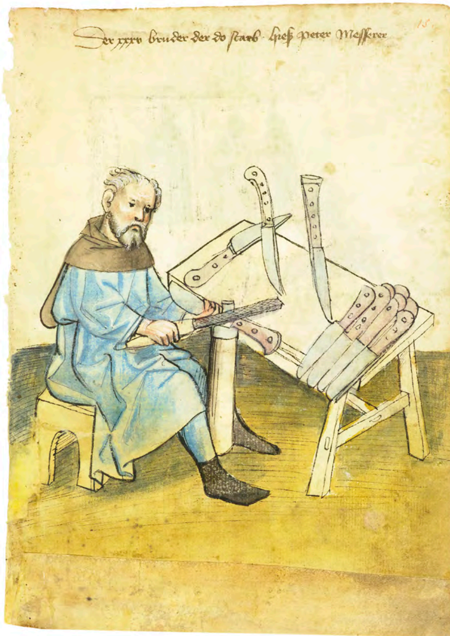
Fig. 159. Cet emmancheur de couteau (Peter Messerer) profile un manche avec une râpe. Extrait des manuscrits du Hausbuch der Nürnberger zwölfbrüderstiftungen, qui regroupent plus de 1300 représentations d'artisans ayant rejoint une confrérie laïque, datés entre la fin du XIV e siècle et le XVIII e siècle (Nuremberg, Nürnberg Germanischen Museum, Stadtbibliothek, Das Hausbuch der Medelsen, Mendel I, Amb. 317,2, fol. 15 r, feuillet daté de 1425; planches consultables en ligne: http://www.nurembergerhausbuecher.de ).
