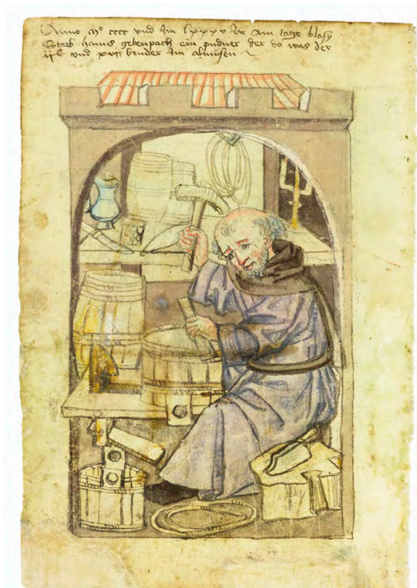
Fig. 176. Hans Gebenpach, tonnelier-cuveleur, sur sa selle de travail cerclant un baquet à l'aide d'un maillet et d'une chasse. À ses pieds et derrière lui, des baquets, tonneaux et tonnelets finis et des cercles en bois liés (Nuremberg, Nürnberg Germanischen Museum, Stadtbibliothek, Das Hausbuch der Medelsen, Mendel I, Amb. 317,2, fol. 103v, vers 1485).
