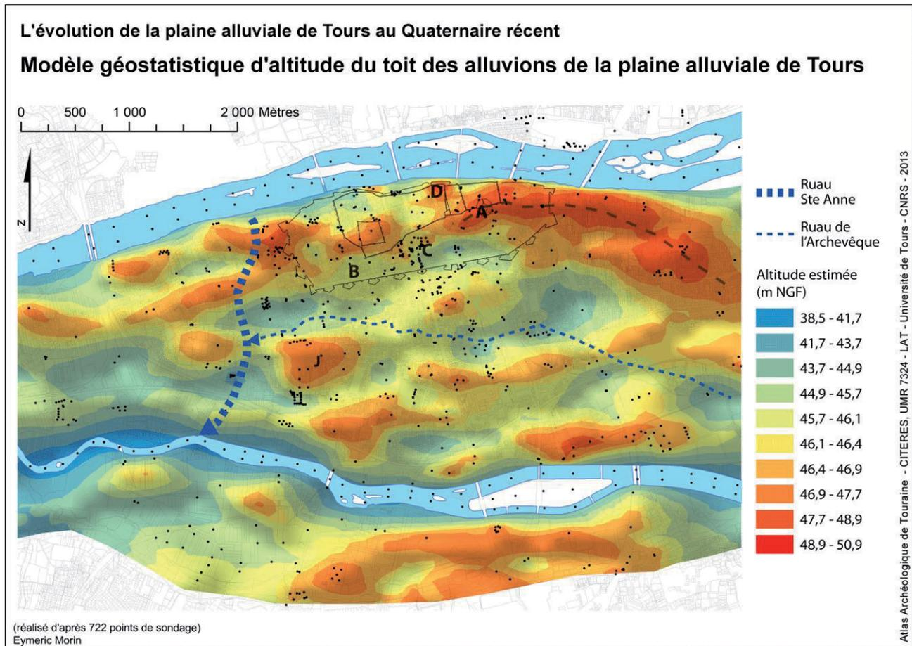
**Document 1.** Modèle géostatistique de l'altitude du toit des alluvions de la plaine alluviale de Tours (réalisé d'après 722 points de sondage). A: point le plus élevé du toit des alluvions en partie ouest de la basse terrasse fluviale ; B: levée naturelle ; C, D: brèche de levée ; E, F: levée naturelle ou barre sédimentaire ; G, H, I, J : levée naturelle ou barre sédimentaire découpée par des talweg ; K, L: île holocène.
