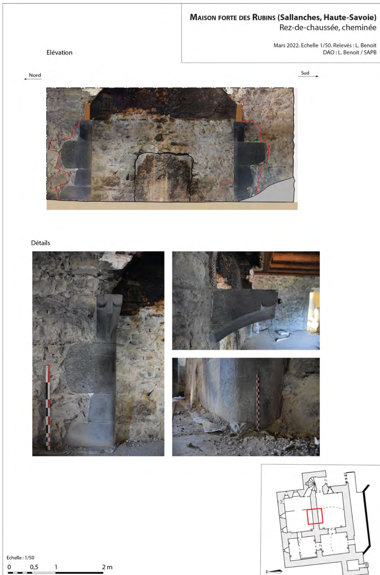
Fig. 11 : Maison forte des Rubins (Sallanches, 74). Relevé de l'élévation de la cheminée du rez-de-chaussée et détails des piédroits. Clichés et DAO : L. Benoit.
