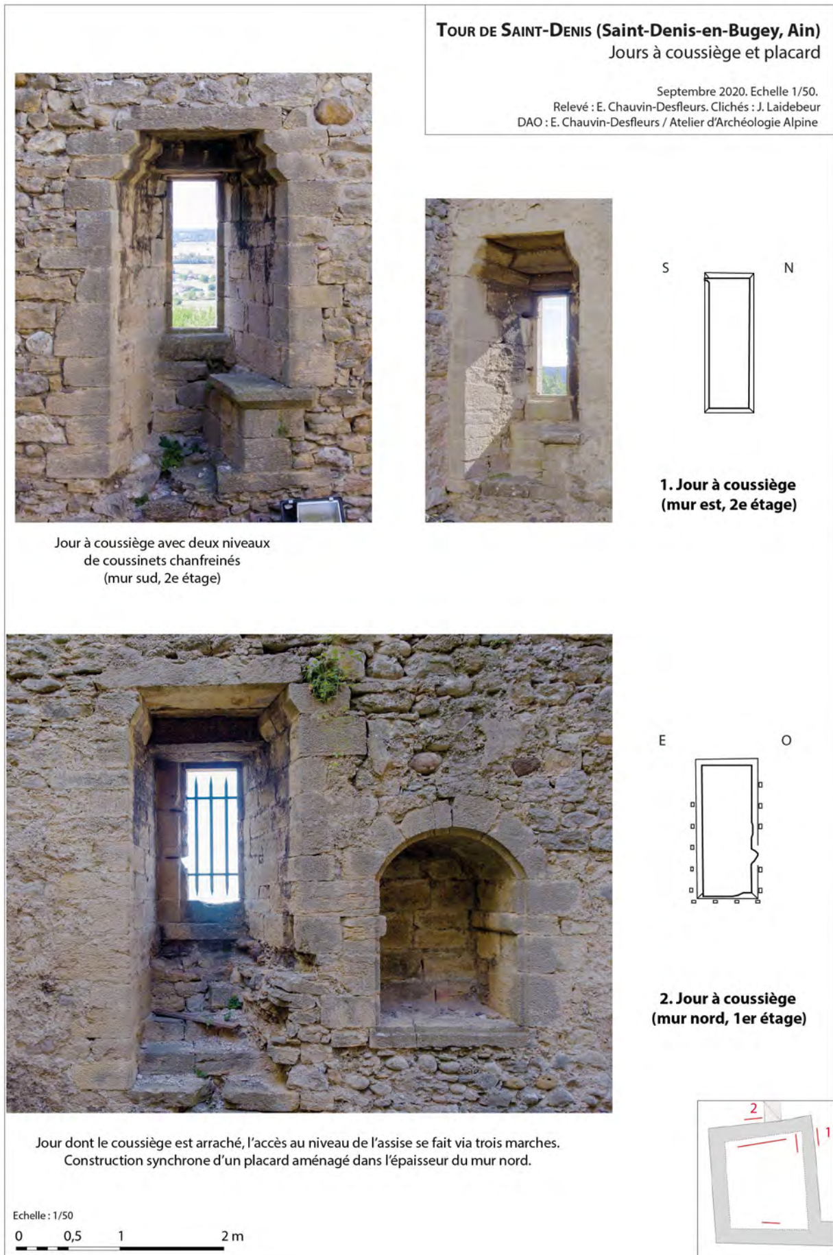
Fig. 28 : Tour de Saint-Denis. Jours à coussiège et placard, relevé au 50e. DAO. : E. Chauvin-Desfleurs.
