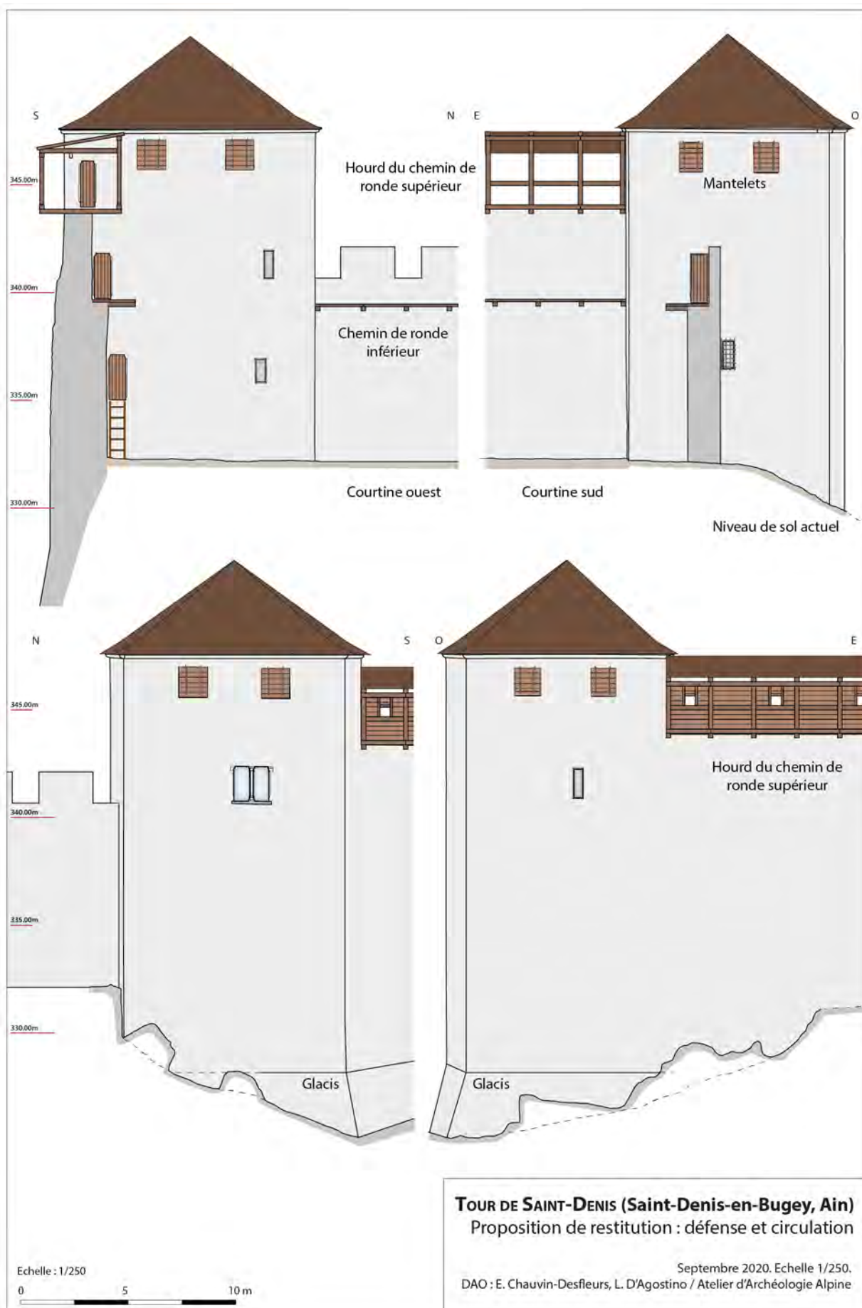
Fig. 32 : Tour de Saint-Denis. Proposition de restitution au 250e. DAO : E. Chauvin-Desfleurs.
