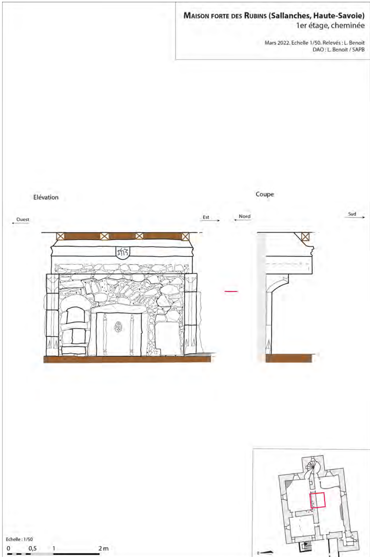
Fig. 12 : Maison forte des Rubins (Sallanches, 74). Elévation et coupe de la cheminée du premier étage. Echelle : 1/50. DAO : L. Benoit.
