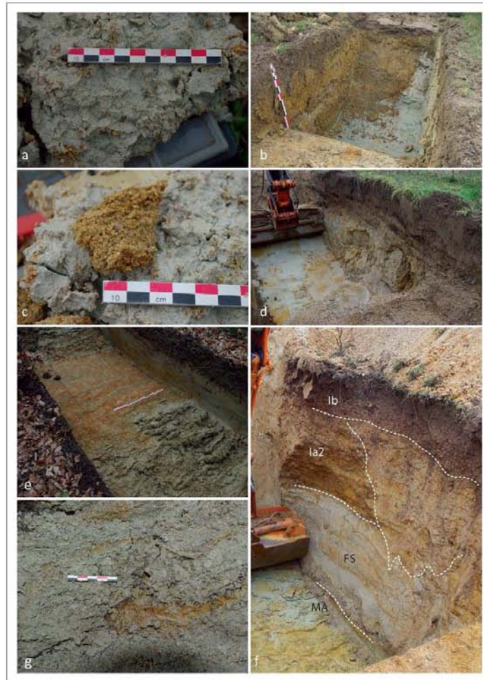
Fig. 3 : Photographies des faciès de la formation de Sologne (AR) et des alluvions Fw à Saint-Cyr-en-Val « La Saussaye ». a/ Faciès argileux gris à gris-vert (SP18 Saint-Cyr-en-Val « La Saussaye » tranche 1). b/ Vue générale du contact des argiles de la formation de Sologne (AR), au fond à droite du sondage, avec les formations alluviales anciennes Fv, à gauche (SP21 Saint-Cyr-en-Val « La Saussaye » tranche 2). Echelle de 1 mètre. c/ Faciès de sables grossiers argileux orange vif (SP18 Saint-Cyr-en-Val « La Saussaye » tranche 1). d/ Faciès de sables grossiers argileux gris/blanc (SP16 sud Saint-Cyr-en-Val « La Saussaye » tranche 1). Sondage de 2 mètres de profondeur. e/ Faciès d'argiles et d'argiles sableuses (SP11 Saint-Cyr-en-Val « La Saussaye » tranche 1). Le coin de glace, déformé et raviné (pseudo-karst ?), est inscrit dans un horizon BT et associé à une forte altération en relation avec l'approfondissement de l'horizon Eg. Notez les litages graveleux obliques à verticaux dans le remplissage. A la base du profil, observation des sables blancs triés et lavés à dragées quartzzeuses du faciès FS de la formation de Sologne qui repose sur les marnes gris-vert de la formation de Beauce MA. Sondage de 3 mètres de profondeur. f/ La formation de Sologne à Saint-Martin d'Abbat : des argiles à slickensides (faces de glissement brillantes) et une agrégation polyédrique à feuilletée selon les faciès des marnes. Fig. 3: Photographs of the Sologne Formation and the "Fw" old alluviums, in Saint-Cyr-en-Val "La Saussaye" part 1. a/ The clay facies, grey to grey/green (SP18 Saint-Cyr-en-Val "La Saussaye" tranche 1). b/ Overview from the Sologne formation clays contact with the old alluvium; clays from the Sologne formation in the north, at the right of the photograph (SP21 Saint-Cyr-en-Val "La Saussaye" tranche 2). Measuring scale: 1 meter. c/ Intense orange clayey and coarse-grained sand facies (SP18 Saint-Cyr-en-Val "La Saussaye" tranche 1). d/ Grey/white clayey and coarse-grained sands facies (SP16 sud Saint-Cyr-en-Val "La Saussaye" tranche 1). The bore hole is 2 meters deep. e/ Sandy clay and clay facies (SP11 Saint-Cyr-en-Val "La Saussaye" tranche 1). Measuring scale: 1 meter. f/ In the Saint-Cyr-en-Val old alluviums (SP1, Saint-Cyr-en-Val "La Saussaye" tranche 1): deformed and probably gullied, ice wedge pseudomorph (pseudokarst?), intersecting the BT horizon and showing a deep weathering related to the Eg horizon deepening. Notice inside the filling the oblique to vertical gravelly beddings. In the bottom part of the mechanical test pit: sorted and washed white sands with small quartz pebbles from the Sologne formation FS deposits on the green/grey marl from the Beauce formation MA. The mechanical test pit is 3 meters deep. g/ The Sologne formation from Saint-Martin d'Abbat: clays with slickensides and polyhedral to lamellar aggregates, according to the marl facies.
