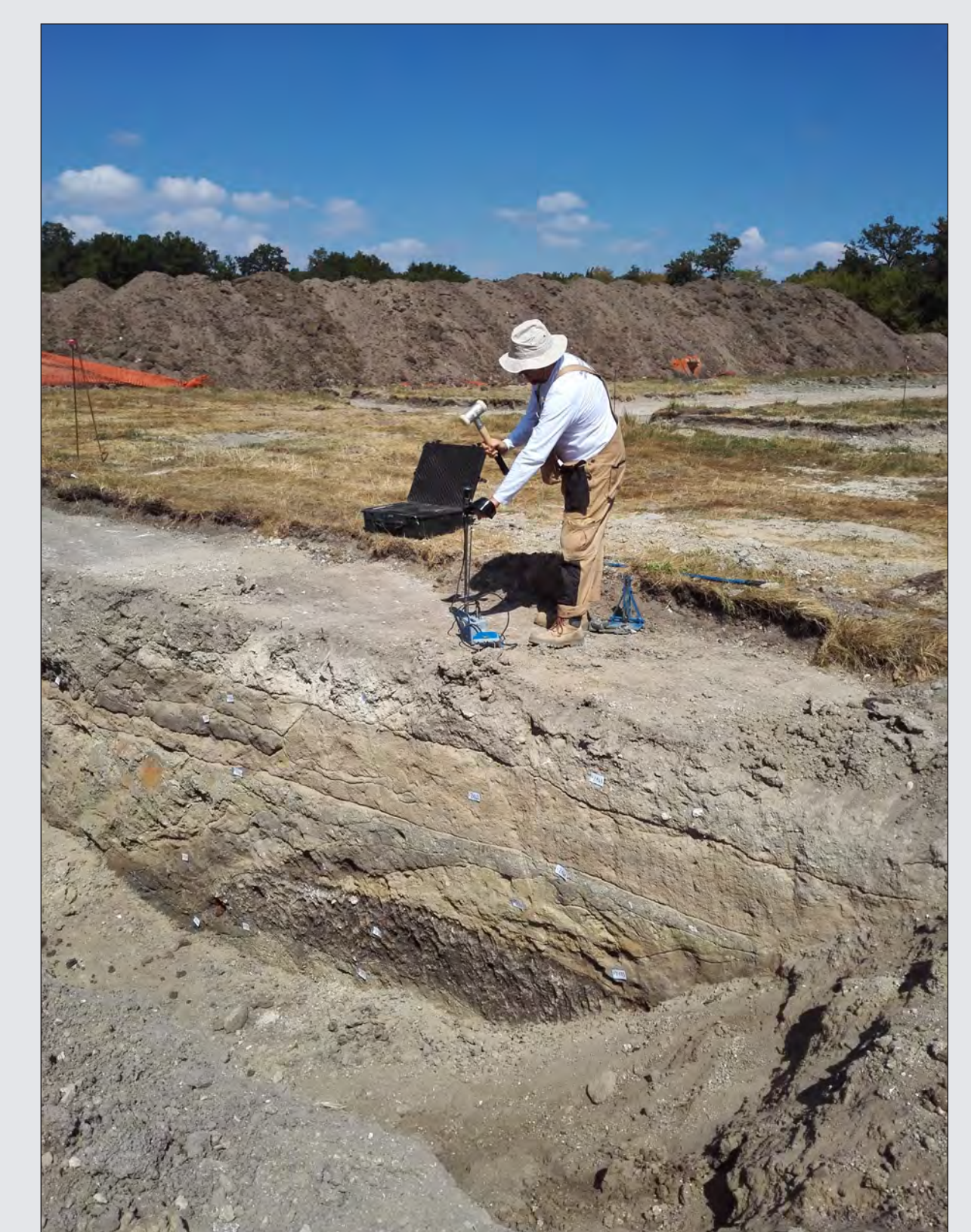
Sondages au PANDA® en bord d'un sondage mécanisé. Etalonnage des données. A. L.-Dehecq, CD45
