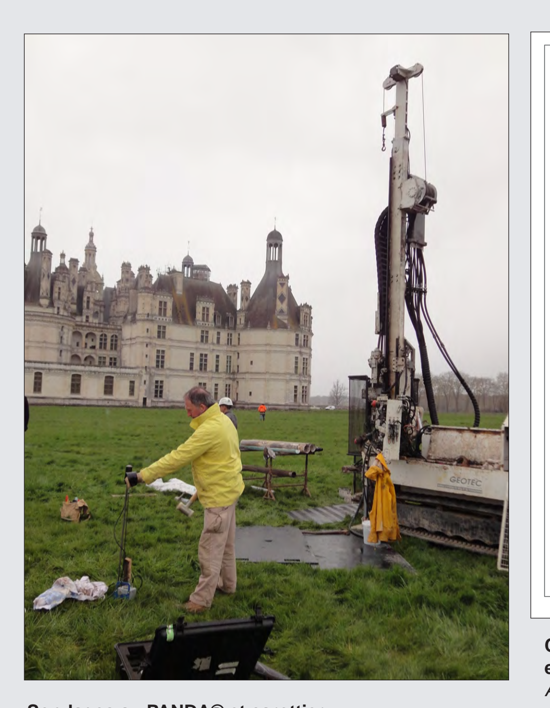
Sondages au PANDA® et carottier A. L.-Dehecq, CD45
