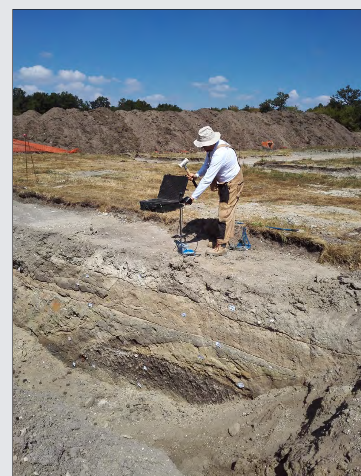
Sondages au PANDA® en bord d'un sondage mécanisé. Etalonnage des données. A. L.-Dehecq, CD45
