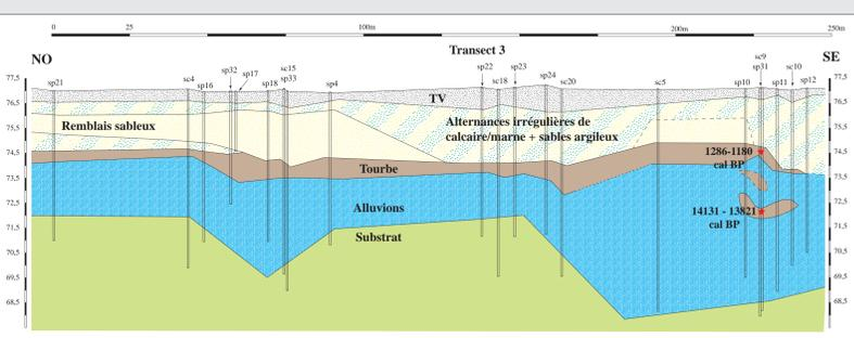
Géométrie des dépôts du transect 3, d'après les sondages carottés et les sondages au pénétromètre. Datation au <sup>14</sup>C de sédiments tourbeux au droit du SC9. P. Gardère, Inrap
