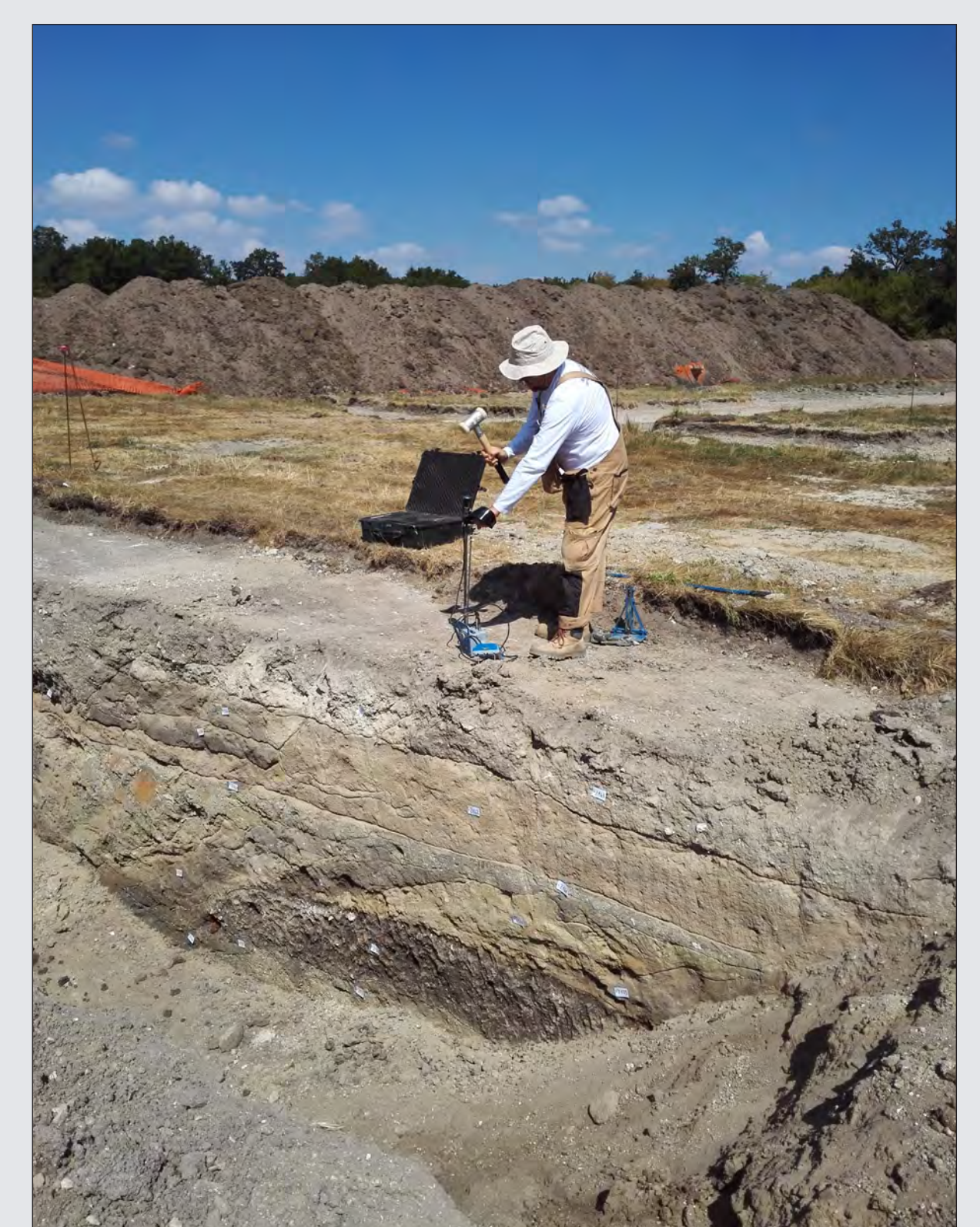
Sondages au PANDA® en bord d'un sondage mécanisé. Etalonnage des données. A. L.-Dehecq, CD45
