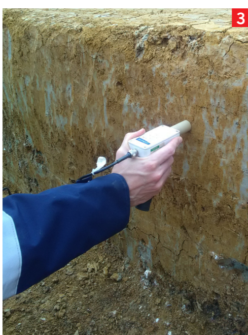
1 Mesure de la susceptibilité magnétique sur surface décapée, Prasville (45), fouille T. Hamon © B. Fores, Inrap 2 Mesure de la différence de la composante verticale du champ magnétique sur surface décapée, Montagnac (34), fouille M. Gandelin © H. Hermet, Inrap 3 Mesure de la susceptibilité magnétique sur coupe © P. Gardès, Inrap 4 Carte de susceptibilité magnétique sur surface décapée permettant de repérer une zone de travail du fer, Mionnay (01), fouille F. Gabayet © F.-X. Simon, Inrap 5 Carte de susceptibilité magnétique sur surface décapée permettant de repérer une zone de travail du fer et carte de micro-déchets de forge, Sauchy-Lestrée (62) Secteur 10, fouille P. Lefèvre © G. Hulin et B. Jago, Inrap
