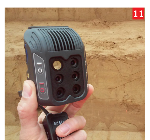
11 Caméra multispectrale 6 bandes Pixinov - Spectra 610 © G. Hulin, Inrap 12 Utilisation de la caméra multispectrale 6 bandes Pixinov sur la fouille de Prasville © M. Groussot, Inrap
