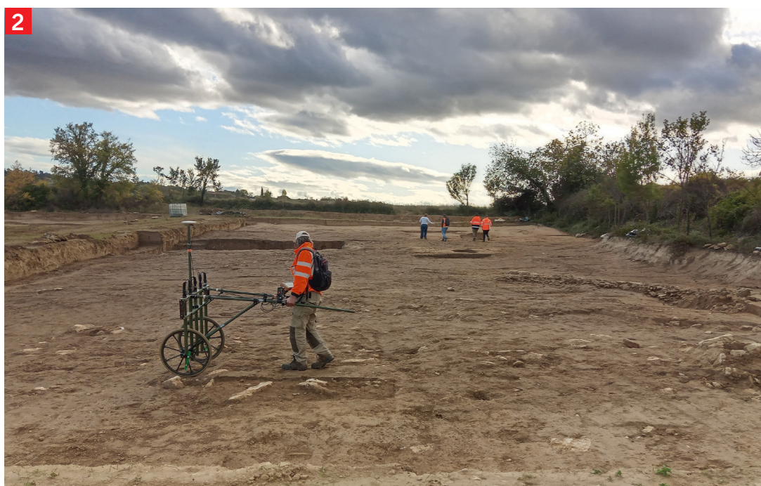
1 Mesure de la susceptibilité magnétique sur surface décapée, Prasville (45), fouille T. Hamon © B. Fores, Inrap 2 Mesure de la différence de la composante verticale du champ magnétique sur surface décapée, Montagnac (34), fouille M. Gandelin © H. Hermet, Inrap 3 Mesure de la susceptibilité magnétique sur coupe © P. Gardès, Inrap 4 Carte de susceptibilité magnétique sur surface décapée permettant de repérer une zone de travail du fer, Mionnay (01), fouille F. Gabayet © F.X. Simon, Inrap 5 Carte de susceptibilité magnétique sur surface décapée permettant de repérer une zone de travail du fer et carte de micro-déchets de forge, Sauchy-Lestrée (62) Secteur 10, fouille P. Lefèvre © G. Hulin et B. Jago, Inrap
