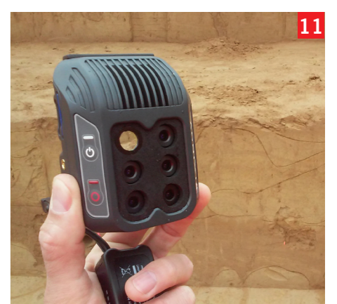
11 Caméra multispectrale 6 bandes Pixinov - Spectra 610 © G. Hulin, Inrap 12 Utilisation de la caméra multispectrale 6 bandes Pixinov sur la fouille de Prasville © M. Groussot, Inrap
