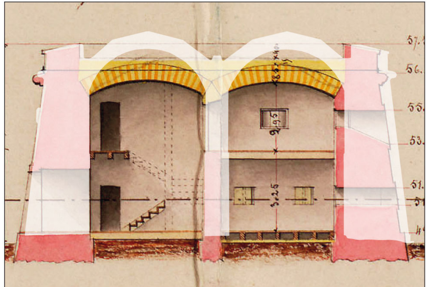
Fig. 6 - Comparaison du profil du bâtiment avec le plan de 1869 et celui de 2020 (en blanc). (FRANOM24_23DFC01602_00_1A et V. Mialhe, Inrap)
