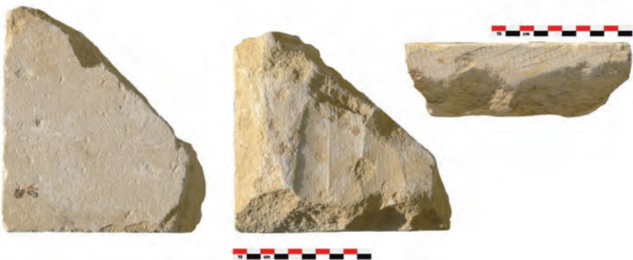
Fig. 133. Dalle de type C. Fragment de l'angle d'une dalle de sol, deux bords conservés. Le dessous de la dalle est obtenu par sciage d'un bloc assez épais en deux ou trois dalles après son extraction en carrière, de manière à obtenir exactement l'épaisseur souhaitée. Nature de la pierre : calcaire à grain fin, jaunâtre, sans fossiles. Pierre de Caen, Bathonien (Jurassique). L. = 16 cm ; l. = 16 cm ; ép. = 4,2 à 4,4 cm. Taille : dessus poli par l'usage. Dessous par sciage. Les traces indiquent que l'ouvrier a peu à peu incliné son outil puis a dû changer de position, et la trace a repris une allure horizontale P ; percussion posée. Tranche obtenue en deux passages : épannelage au têt, mise aux mesures et finition directement à la brettature ; percussion lancée.
