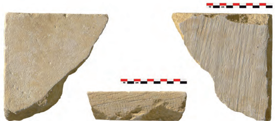
Fig. 133. Dalle de type C. Fragment de l'angle d'une dalle de sol, deux bords conservés. Le dessous de la dalle est obtenu par sciage d'un bloc assez épais en deux ou trois dalles après son extraction en carrière, de manière à obtenir exactement l'épaisseur souhaitée. Nature de la pierre : calcaire à grain fin, jaunâtre, sans fossiles. Pierre de Caen, Bathonien (Jurassique). L. = 16 cm ; l. = 16 cm ; ép. = 4,2 à 4,4 cm. Taille : dessus poli par l'usage. Dessous par sciage. Les traces indiquent que l'ouvrier a peu à peu incliné son outil puis a dû changer de position, et la trace a repris une allure horizontale P ; percussion posée. Tranche obtenue en deux passages : épannelage au têt, mise aux mesures et finition directement à la brettature ; percussion lancée.
