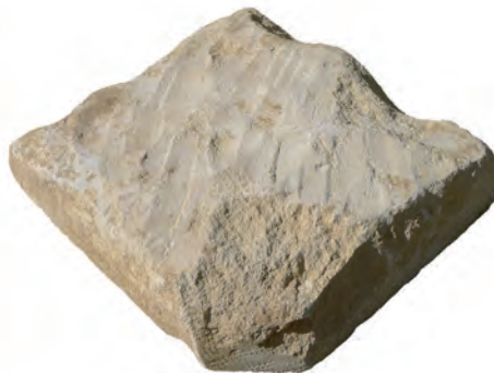
Fig. 139. Dalle 182-2. Dessous : vue du dessous, vue en oblique (la retaille de l'angle, avec dégagement d'un grand éclat, est bien visible) ; détail de la tranche. Dalle presque carrée, avec un angle abattu. Type B. Nature de la pierre : calcaire à grain fin, jaunâtre, sans fossiles. Pierre de Caen, Bathonien (Jurassique). L. = 32,1 cm ; l. = 30 cm ; ép. = 7 cm ; poids = 11,210 kg. Taille : débitage initial du bloc en carrière probablement sur fissure, avec retaille générale à la laye au taillant légèrement courbe, large de 7 à 8 cm. Bords obtenus par retaille à la chasse ou au têtou avec finition à la bretture. L'angle abattu a été obtenu, probablement au moment de la pose, par retaille. Une première retaille a provoqué un large éclat, tandis que la finition a été faite avec une bretture semblable à celle utilisée pour les côtés (M. Viré / Inrap).
