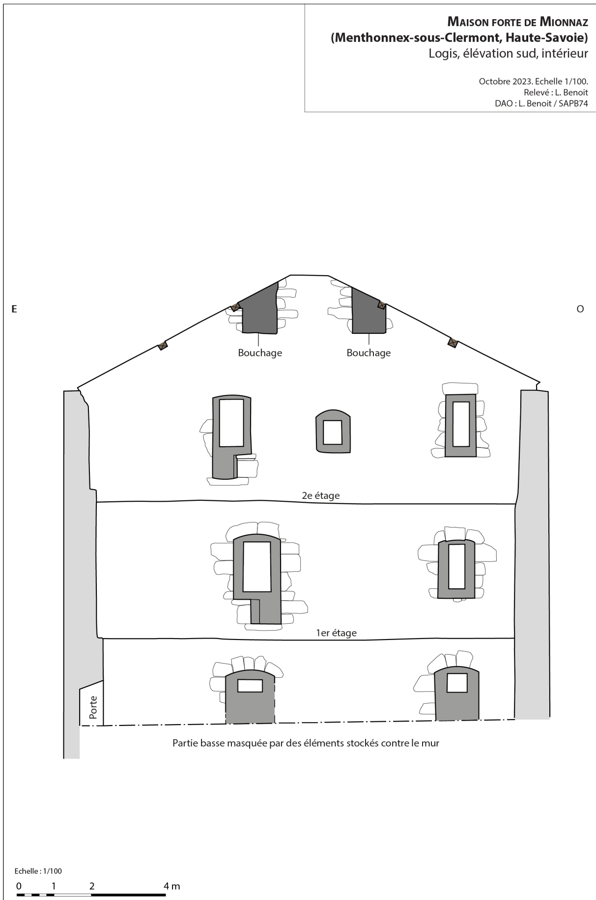
Figure 148 : Mionnaz (74). Logis, mur sud, parement interne. DAO : L. Benoit.
