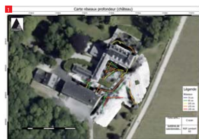
1 La détection des réseaux du domaine privé, avec rendu cartographique des profondeurs a permis une intervention mécanique et humaine en totale sécurité. © Analyse GC
