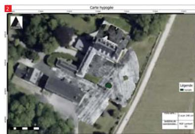
2 En revanche, la recherche de cavité enfouies sous la craie a seulement mis en évidence l'hypogée n°6, non comblé. Il faut préciser que la détection n'a pas été intégrale à l'aplomb de l'hypogée n°7, classé et notoirement vide, en raison de la présence d'un imposant sapin.
