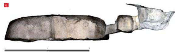
7 Un relevé photographique complet de l'hypogée n°6 a été réalisé au travers de plus de 500 clichés haute définition (Samsung NX 1000, focale 18 mm, 5472x3648 pixels) et la pose de cibles géolocalisées et à l'entrée du trou d'homme. L'ensemble a ensuite été calculé en nuage de points et texturé via le logiciel Agisoft Photoscan (a) afin d'en exporter un fichier .obj de maquette tridimensionnelle, opérable sous CloudCompare (b) qui permet la géolocalisation et la manipulation de l'objet.
