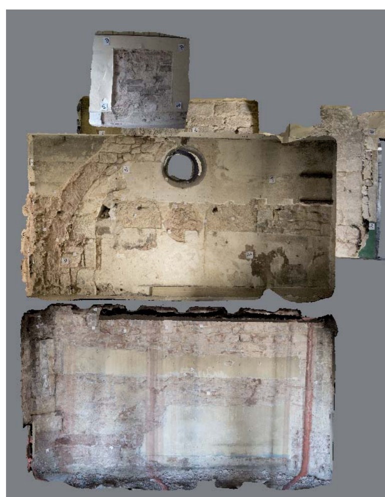
7 Vue orthorectifiée du chœur d'après le modèle 3D et restitution graphique de son élévation
