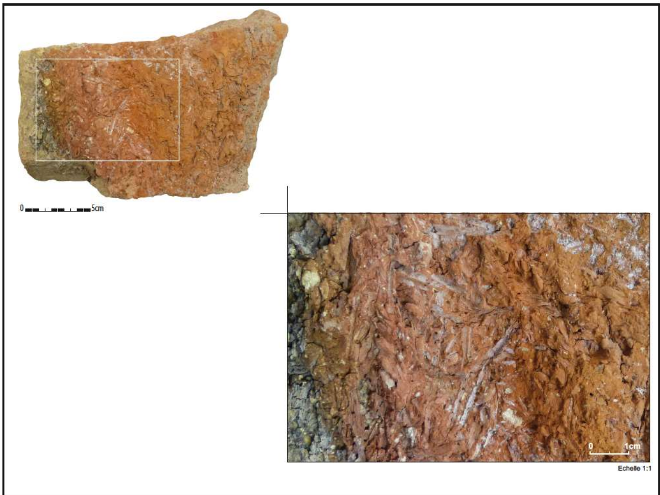
Fig. III-03-07 Détail d'un liant argileux avec négatifs de dégraissant végétal, au revers d'une tegula employée dans les maçonneries de la chambre de chauffe du four FOU1074, Melun « 19, rue Saint-Liesne » © Inrap : G. Chamarre
