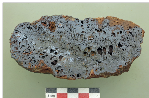
D : TR02, ram. 10036, culot de forge, section sciée transversale
