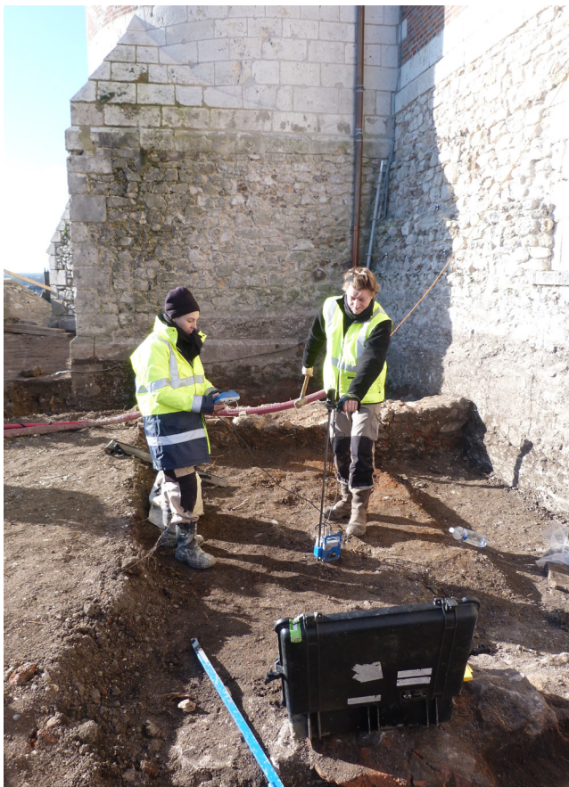
Fig. 3 - Mise en œuvre du dispositif PANDA® sur le site du château de Gien. (Département du Loiret, M. Bizri, UMR 6298 Artheis, 2011)
