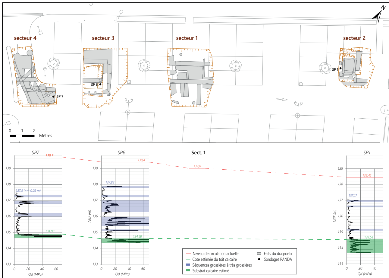
Fig. 20 - Estimation de la cote du toit calcaire pour la profondeur d'aménagement d'un réservoir d'eau enterré sur le site de la Place Cujas à Bourges. (M. Fondrillon, Bourges-Plus, UMR 7324 CITERES - LAT, 2023)
