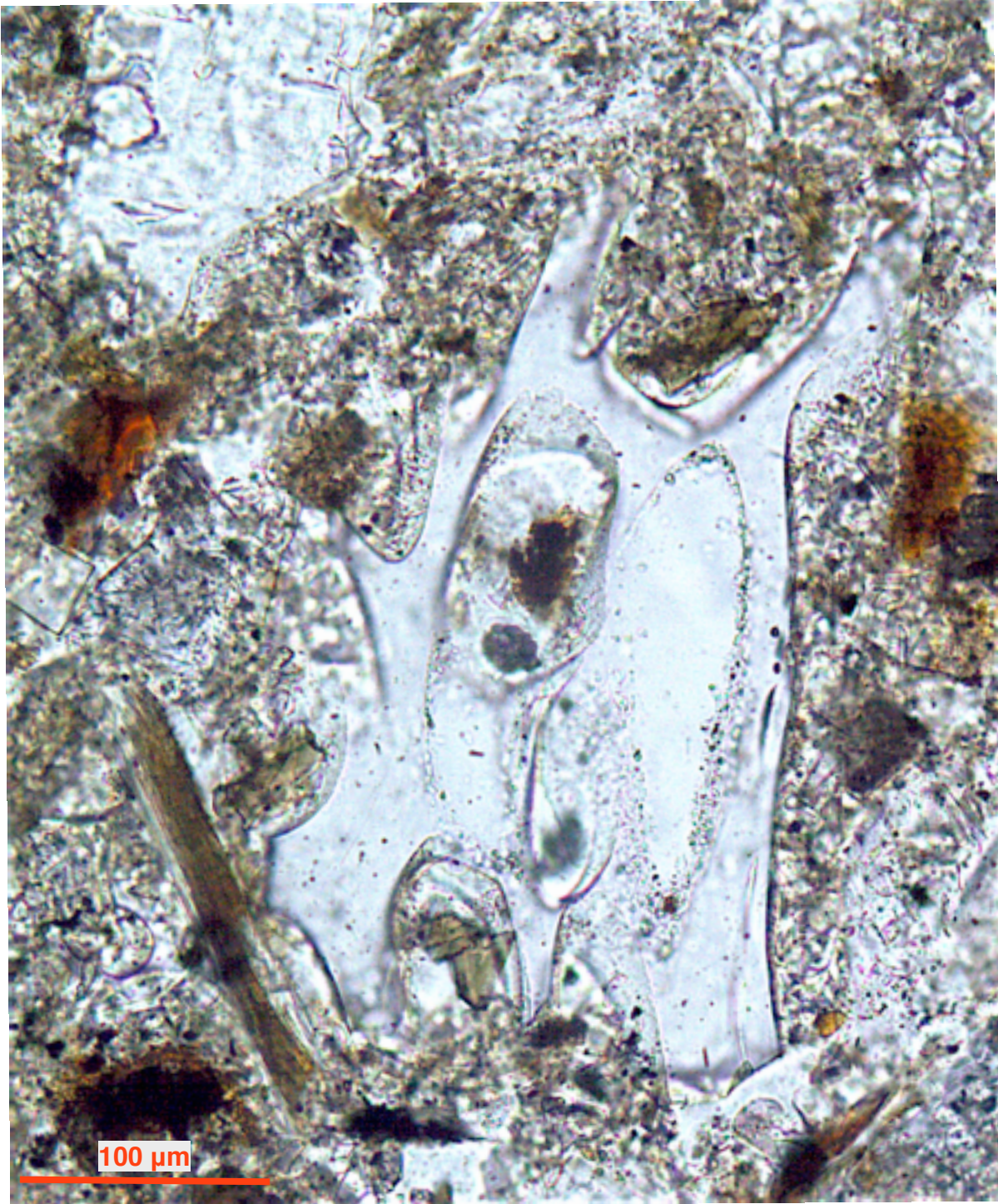
Figure 82 : Echarde poncée et minéraux libres fragmentés dans la matrice fine du bloc B3.
