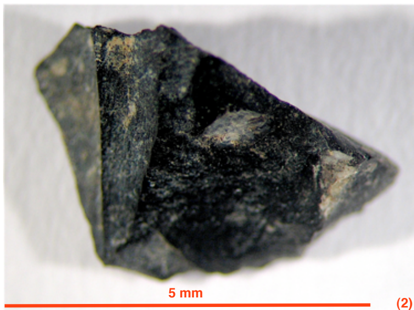
Figure 53 : Hyaloclastes, de couleur noire brillante, non vésiculés et anguleux ; téphra CF4, (1) site de Gerzat-Chantemerle et (2) site de Nohanent-lotissement (binoculaire, LN réfléchie, X10). Fracturation plane (1) à conchoïdale (2).
